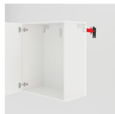
Plaats de tilborging in de sleuf om de kast op te hangen.
